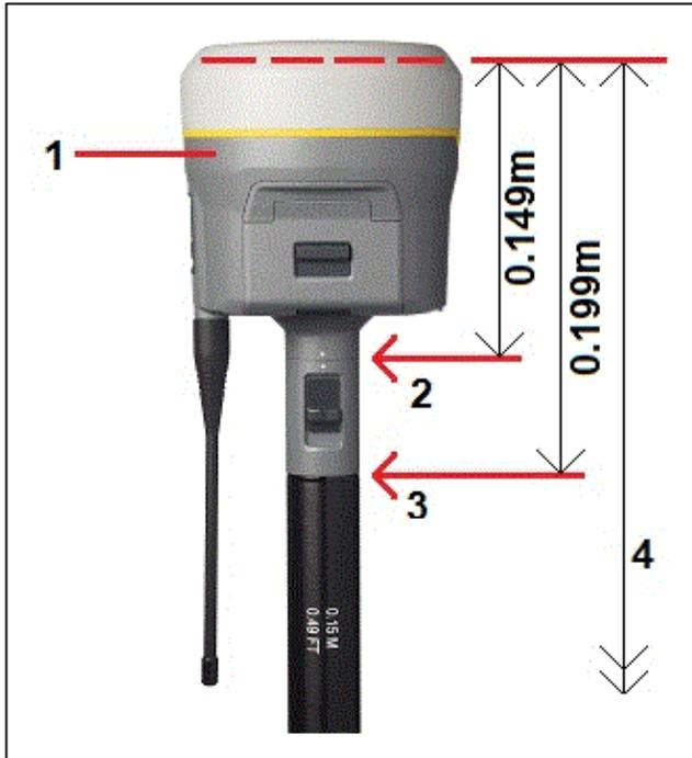
A seguir demonstra-se como medir a altura de um receptor Receptor Trimble R10 utilizando o indicador de nível da extensão R10, quando o R10 é montado sobre um tripé.
