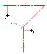
Исключением является случай, когда расстояние от точки (2) до точки пересечения больше, чем расстояние до другого элемента разбивочного элемента в плане. В этом случае пикет и смещение для точки вычисляется до ближайшего элемента.
