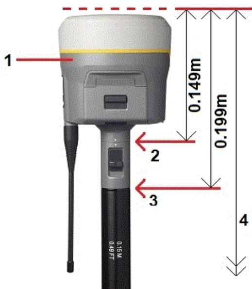
Ce qui suit décrit comment mesurer la hauteur d'un Récepteur Trimble R10 à l'aide du levier sur l'extension R10, lorsque le R10 est monté sur un trépied.
