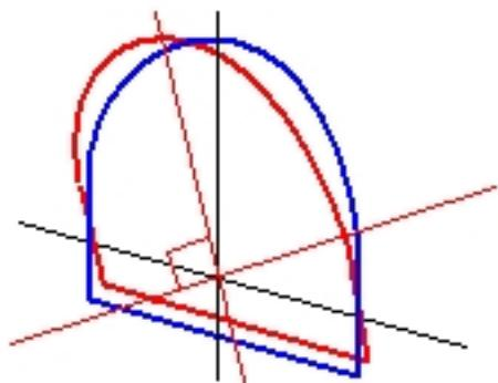
只有垂直于定线的点的测站和偏移量显示将用 点管理器 或 检查任务 相对于隧道而计算出来。如果模板正交于隧道位置应用，测站和偏移量将会不同。
