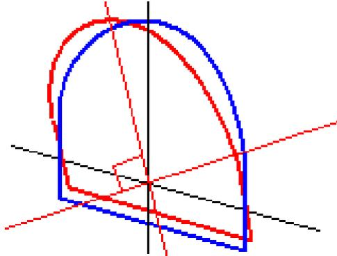
ポイントマネージャまたはジョブのレビューを使用したトンネルを基準とするポイントのステーションおよびオフセット表示は、線形に対して鉛直にのみ計算されます。テンプレートがトンネル配置で垂直に適用される場合は、ステーションとオフセットは異なるものになります。
