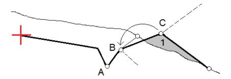
Avec la polyligne B sélectionné comme la polyligne d'épaulement, la pente en déblai peut être définie en conservant la valeur de pente du projet ou en entrant une autre valeur au clavier. Alternativement, la pente en déblai peut être définie en sélectionnant l'une des options suivantes :
