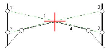
Typiquement un fil (1) est tendu d'un côté de la route à l'autre attaché à la position (2) sur chaque jalon. A la suite, le fil est contrôlé afin de s'assurer qu'il se trouve bien sur la surface de la route formée (4). Ensuite, on repète la procédure popur l'autre côté de la route en attachant le fil aux jalons à la position
