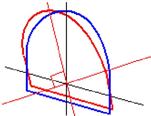
La stazione e la visualizzazione dell'offset di punti relativi a un tunnel se si utilizza **Manager punti** o **Esamina lavoro** vengono calcolati solo verticalmente rispetto all'allineamento. Se i modelli vengono applicati perpendicolarmente in un posizionamento tunnel, la stazione e l'offset saranno diversi.
