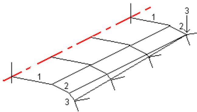
Лучший способ управления процессом интерполяции для максимального соответствия проекту трассы - это добавление секций с нулевым сдвигом.
