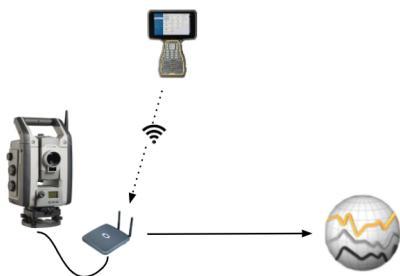
2. Отключите управление инструментом Settop M1 с помощью программного обеспечения Мониторинг. Для этого коснитесь **≡** выберите **Обмен данными / Settop M1 / Отключить управление инструментом**. Введите имя пользователя Settop M1 и пароль, затем нажмите **Отключить**.
