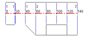
Beachten Sie auch beiden Regelquerschnitte in der folgenden Abbildung, in der der Regelquerschnitt 1 (in der Abbildung links) zwei Oberflächen und der Regelquerschnitt 2 drei Oberflächen hat:
