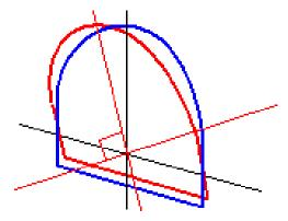
Die Anzeige von Station und Offset für Punkte relativ zu einem Tunnel unter Verwendung des Punktmanagers oder der Funktion Job überprüfen werden nur vertikal zum Kurvenband berechnet. Wenn die Regelquerschnitte in der Tunnelpositionierung rechtwinklig angewendet werden, dann sind Station und Offsets unterschiedlich.
