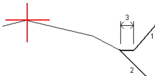
**TIP** – Beim Abstecken eines Seitengefälles werden die Angelpunktposition und ggf. die Position des Angelpunkts für das Abtragsgefälle in der Karte angezeigt und können ausgewählt und absteckt werden.
