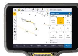
Wählen Sie Ihren bevorzugten Trimble-Controller mit Windows® oder Android™ und stellen Sie eine Verbindung mit der gesamten Palette von konventionellen Trimble Geospatial Totalstationen oder GNSS-Empfängern her, um topografische Vermessungen, Absteckungen, 3D-Scans und örtliche Anpassungen durchzuführen. Durch das Integrated Surveying-System können Sie Daten terrestrischer Vermessungen, Scandaten und GNSS-Daten in demselben Job kombinieren.
