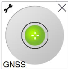
Der Kreis an der **eBubble** steht für die konfigurierte Neigungstoleranz. Die **Neigungstoleranz** (oder auch Neigungsbereich) ist die durch die Neigung gegenüber den Antennenhöhe erzeugte Strecke am Boden (**Neigungsstrecke**).
