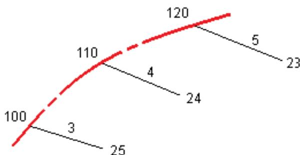
Sin embargo, si el ángulo de desviación de la cadena 3D comparado con el ángulo de la cadena 6D asociada es superior a los 30 minutos, la geometría de la cadena 6D asociada se ignorará y las coordenadas se calcularán mediante la interpolación lineal. Esto es para evitar un comportamiento inesperado cuando hay un cambio de dirección pronunciado en la cadena 3D para características tales como carriles de deslizamiento, entradas para autobuses etc.
