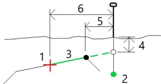
Los detalles de replanteo para la carretera secundaria sobre la que se informa en la pantalla **Confirmar incrementos replanteo** incluyen la Dist.V. a carretera **(4)**, la D.eje de construcción horizontal (calc.) **(5)** y la Distancia a alineación **(6)**.
