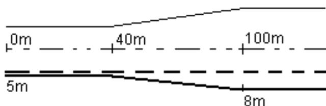
Si selecciona una distancia al eje/cadena que tiene un valor de distancia al eje de 5m, el valor de distancia al eje se actualizará para seguir la línea continua en las estaciones subsiguientes. En este ejemplo, la distancia al eje cambia de 5m a 8m entre las estaciones 40m y 100m y luego se mantiene en 8m para las estaciones siguientes.
