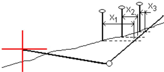
La vista del plano muestra la posición de intersección calculada. El valor de pendiente calculado (en azul) y el valor de la pendiente de diseño aparecen en la parte superior de la pantalla.
