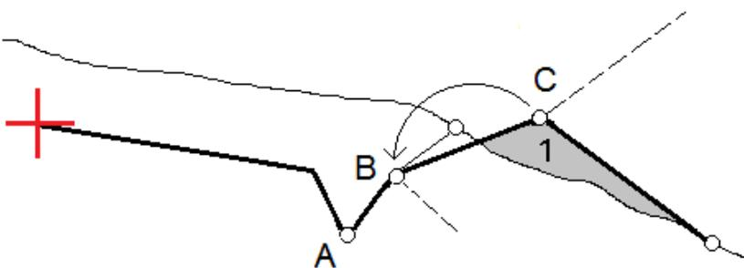
Con la cadena **B** seleccionada como la cadena de unión, el talud puede definirse ya sea reteniendo el valor de talud de diseño o tecleando otro valor. Alternativamente, el talud puede definirse seleccionando una de las siguientes opciones:
