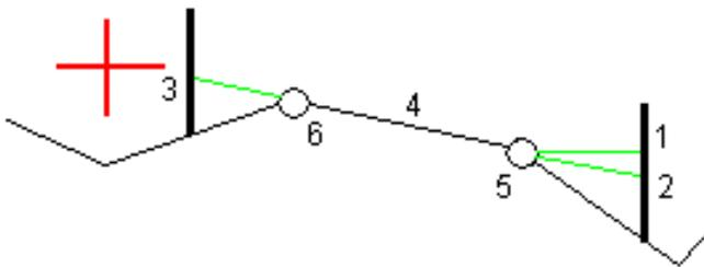
**NOTE** – Para puntos con distancia al eje de cero, no se podrán aplicar distancias al eje de construcción horizontales en un valor de pendiente de la línea anterior.
