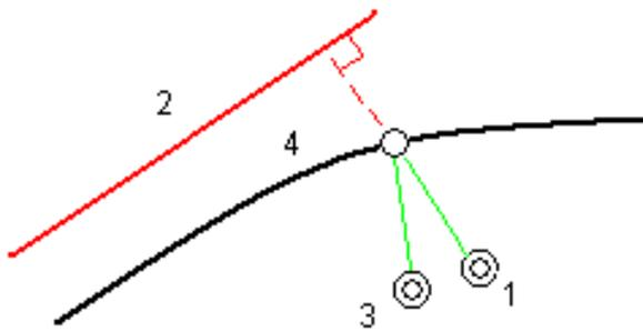
Al replantear estaciones en una cadena, podrá definir una distancia al eje horizontal por la distancia desde la posición seleccionada hasta la alineación. Para ello:
