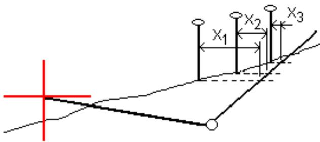
평면도 보기에는 계산 캐치 위치가 표시됩니다. 화면 상단에는 계산 경사값(파란색)과 설계 경사값이 나옵니다.
