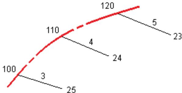
하지만 3D 스트링의 편각이 연관 6D 스트링의 그것에 비해 30분 이상 크면 연관 6D 스트링의 지오메트리가 무시되고 좌표는 대신 선형 보간에 의해 계산됩니다. 이것은 슬립 레인이나 버스 베이 등과 같은 피쳐의 3D 스트링의 방향에 급격한 변화가 있을 경우 예기치 않은 결과를 피하기 위함입니다.
