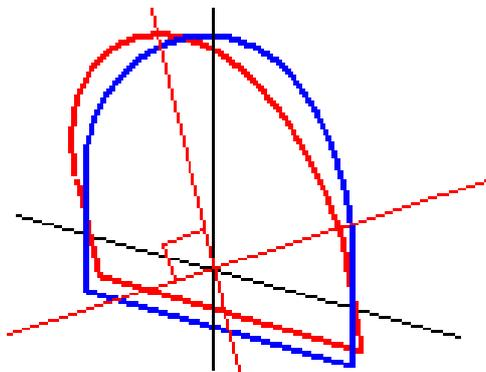
L'affichage de points de station et déport relatif à un tunnel utilisant **Gestionnaire de points** ou **Revoir l'étude** n'est calculé qu'à la verticale à l'alignement. Si les profils en travers type étaient appliqués perpendiculaires dans le positionnement du tunnel alors la station et les déports seront différents.
