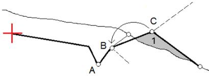
Если секция В выбрана в качестве бровки, выемка откоса может быть определена путем сохранения значения проектного уклона или вводом другого значения. Иначе, выемка откоса может быть определена одним из следующих способов:
