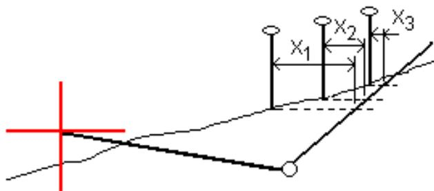
Вычисленное положение точки пересечения отображается в виде плана. Вычисленное значение уклона (синее) и значение проектного уклона отображаются в верхней части экрана.
