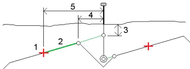
Информация об отклонениях разбивки вторичной трассы отображается на экране Подтверждение отклонений разбивки и включает: Высоту до трассы (3), Строительный сдвиг в плане (вычисленный) (4) и Расстояние до разбивочного элемента (5).
