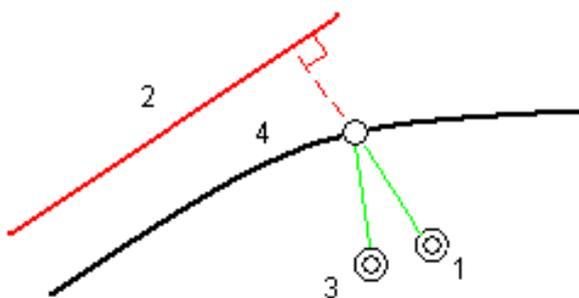
При разбивке пикетов на секции можно задать сдвиг в плане расстоянием от выбранного положения до осевой секции. Для этого:
