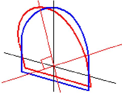
Отображение точек в виде пикетов и сдвигов относительно туннеля с использованием Менеджера точек или Просмотра проекта вычисляется только вертикально к разбивочному элементу. Если шаблоны были применены перпендикулярно в Позиционировании туннеля, то пикет и сдвиги будут различаться.
